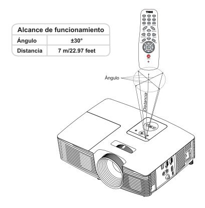
**NOTA:** El alcance de funcionamiento real puede ser ligeramente diferente al indicado en el diagrama. Las pilas gastadas también impedirán que el mando a distancia haga funcionar correctamente el proyector.
